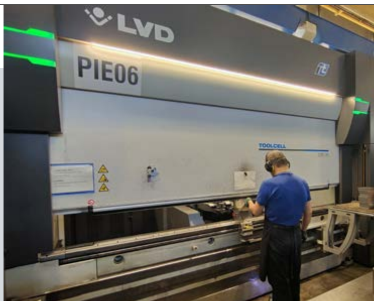
Dotata di cambio utensili automatico, anche in Tomatis Lamiere la pressa piegatrice ToolCell di LVD viene impiegata per ottimizzare la lavorazione di lotti piccoli e medi, anche ad alta complessità
