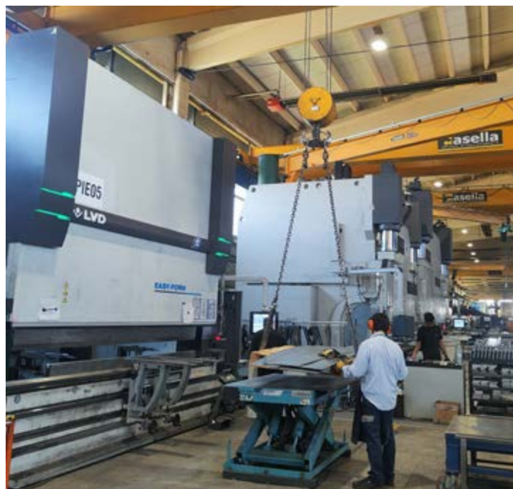
Nel reparto di piegatura Tomatis Lamiere dispone di una decina di impianti LVD, comprensivi di postazioni stand-alone e di una potente configurazione Tandem
