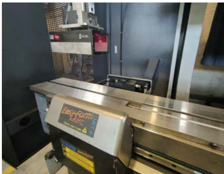
Molto apprezzato da Tomatis Lamiere, l'esclusivo brevetto LVD Easy-Form per il controllo dell'angolo di piega fa parte della dotazione standard di tutte le piegatrici acquistate, sin dalla prima del 2016
