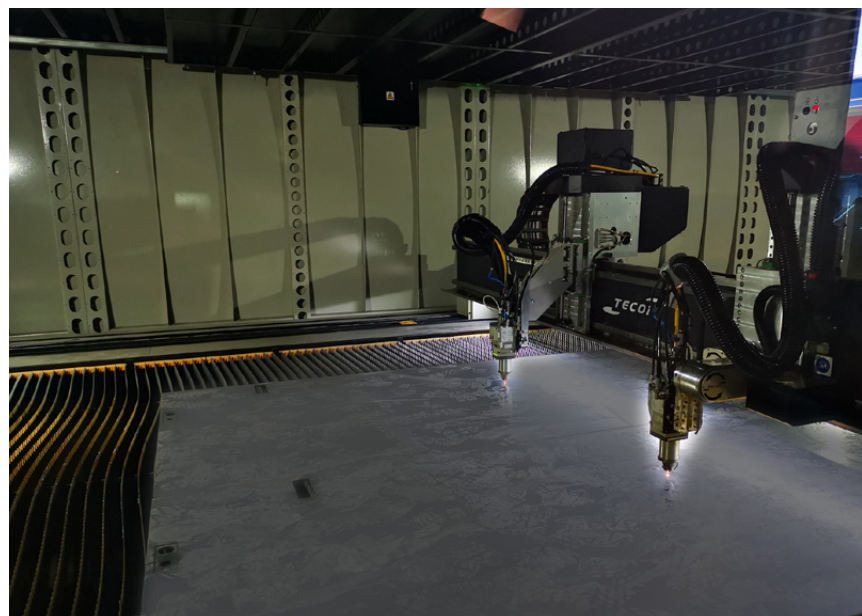
L'evoluto sistema automatico di cambio fibra DFP e il taglio a doppia testa Twin Disk del nuovo laser LS Series Tecoi, consentono a Tomatis Lamiere di ottenere un'elevata capacità produttiva e la massima flessibilità operativa
