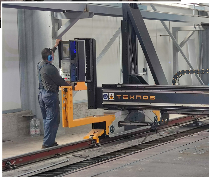
Il nuovo impianto di taglio al plasma Tecoi Teknos installato in Tomatis Lamiere è provvisto di unità di foratura ISO 50 con cambio utensile automatico, una testa Bevel e vanta un campo di lavoro di 3.000 x 24.000 mm con banco autopulente
