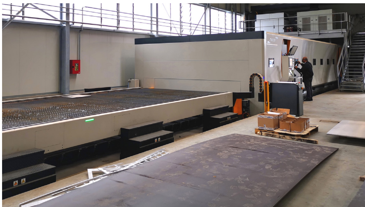
Vista del nuovo impianto di taglio laser a fibra Tocai LS Series a doppia testa, di cui una Bevel, recentemente installato in Tomatis Lamiere
